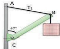
2. Un brazo sostiene un peso 8829 N, como se muestra en la figura. Hallamos la tensión  $T_1$ :
